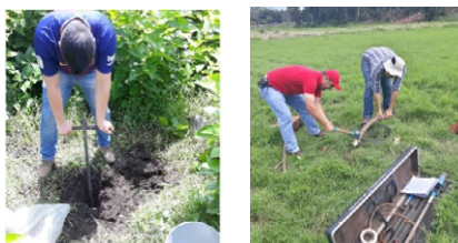
Figura 1. Prueba con cilindros infiltrómetros.
